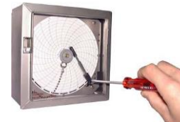
零位设置：轻轻的转动塑料螺丝。正常使用时，不需要调整零位
