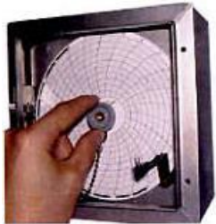
逆时针旋转发条旋钮。最多旋转5圈
